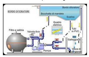
L'acqua contenuta all'interno di una piscina, se lasciata a se stessa, rimarrebbe stagnante e, nel giro di qualche giorno, a causa del depositarsi di impurità e per l'azione dei raggi solari, perderebbe le proprie caratteristiche di balneabilità con il proliferare di microorganismi animali (batteri, ecc.) e vegetali (alghe). Al fine di evitare quanto sopra l'acqua deve essere ciclicamente filtrata (meccanicamente) e trattata chimicamente (disinfezione).
